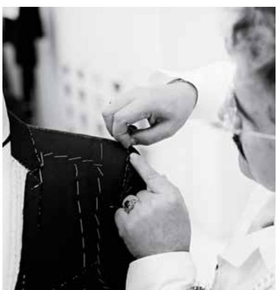
**Un maître tailleur ajuste le prototype d'une veste sur un mannequin Stockman. A master tailor adjusts the mock-up of a jacket on a Stockman dummy.**
